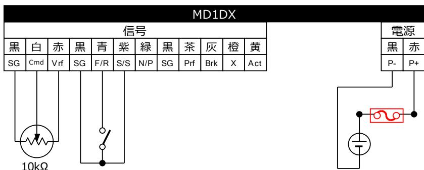
S/S を SG へ結線、ボリュームと回転方向切換用トグルスイッチを結線
