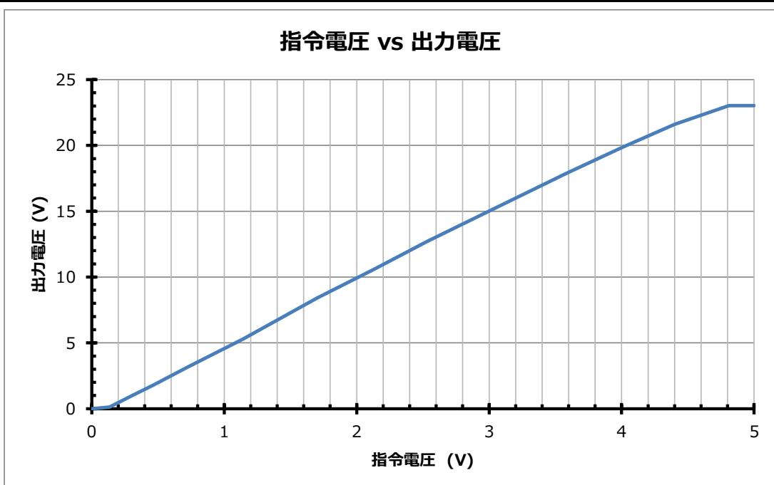
MD1D-CV□□の指令電圧と出力電圧の特性図
